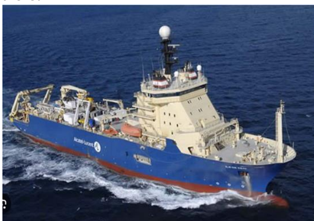
Déploiement de câbles par bateau spécialement équipé (« câblier »)
